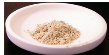
図b 表面をコーティング処理した土壌
